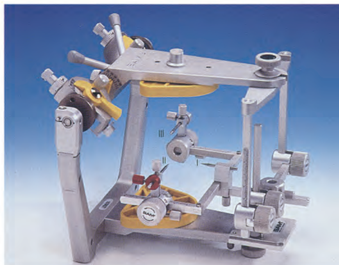
Abb. 9 „Modell-Repositionierungs-Instrument“ mit den Meßspitzen I, II und III, hier montiert am Artikulator SAM 3.
